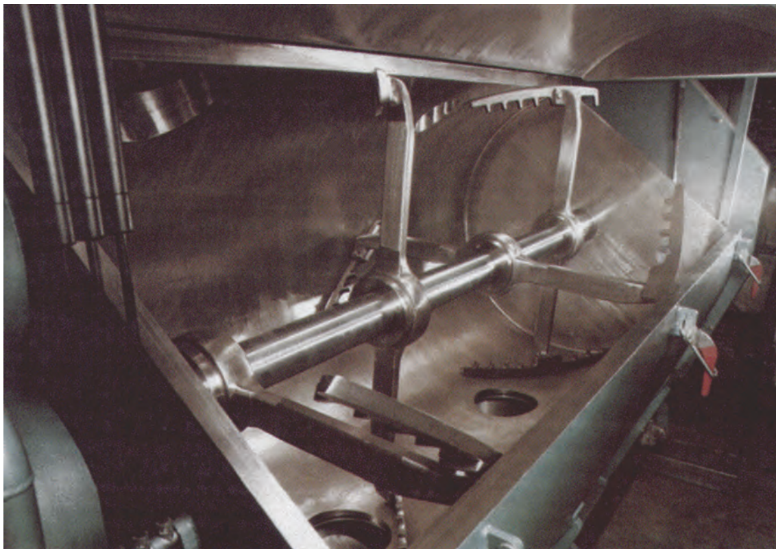
Abbildung 19: Prinzip eines Horizontalmischer (oben). Das Bild links zeigt einen geöffneten Horizontalmischer. [Bild: Prof. Dr.-Ing. Drs. h. c. Manfred H. Pahl, Universität Paderborn]
