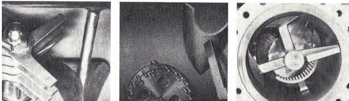
Abbildung 16: Beispiele von Misch-Werkzeugen (oben) und Desagglomerier-Werkzeugen (unten) [Bild: Prof. Dr.-Ing. Drs. h. c. Manfred H. Pahl, Universität Paderborn]
