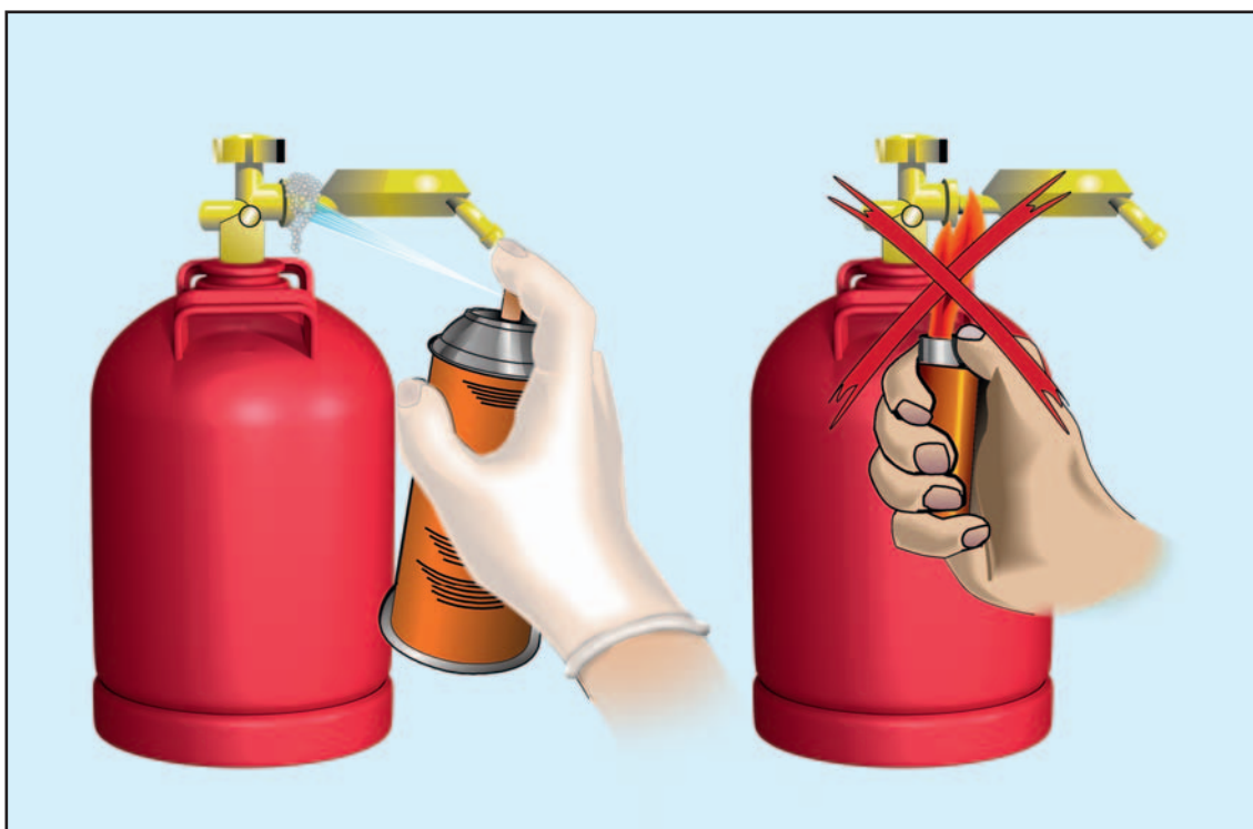
Figure 40 : Contrôle d'étanchéité sur une installation de GPL
