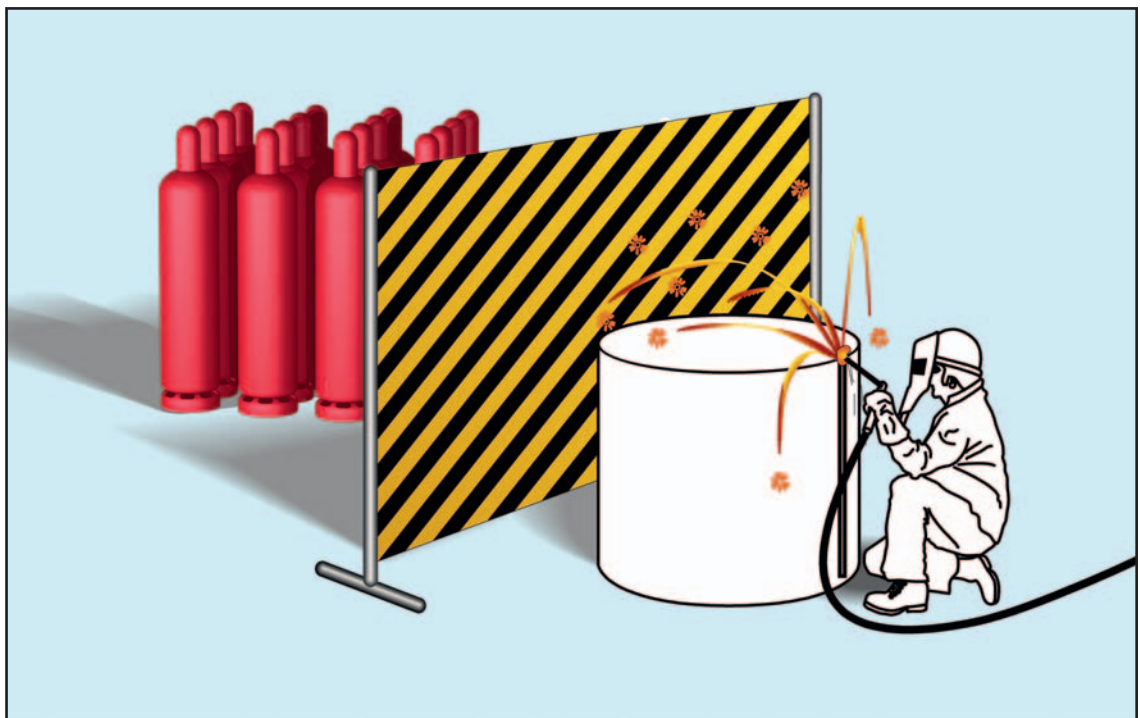
Figure 45 : Mesures de protection particulières lors du soudage dans des zones à risque d'incendie et d'explosion
