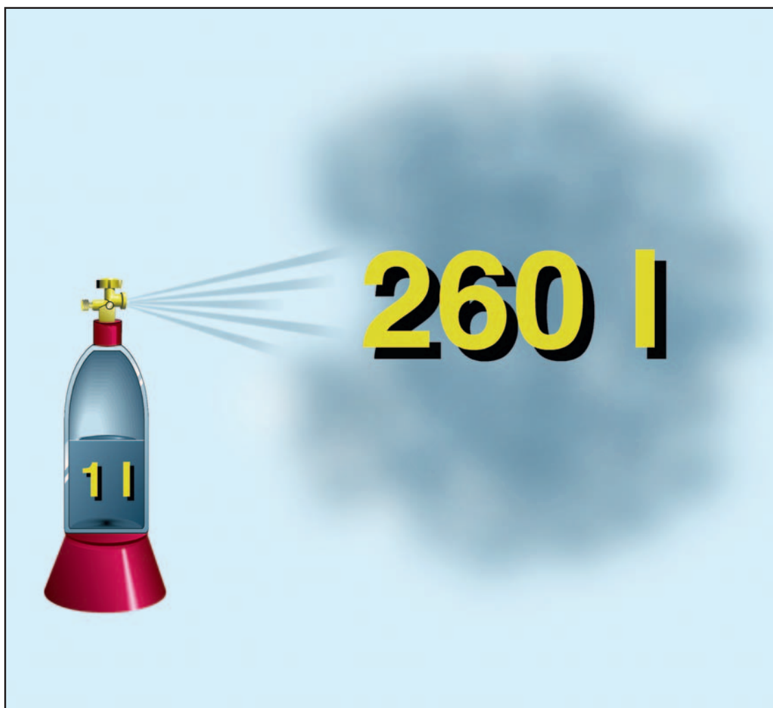
Figure 12 : Augmentation de volume du propane lorsqu'il passe de l'état liquide à l'état gazeux
