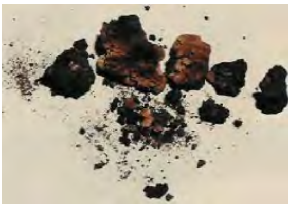
Bild 9: Verkohltes Produkt aus dem Motorraum eines Radladers (Bild: Prof. Siegfried Radandt)
